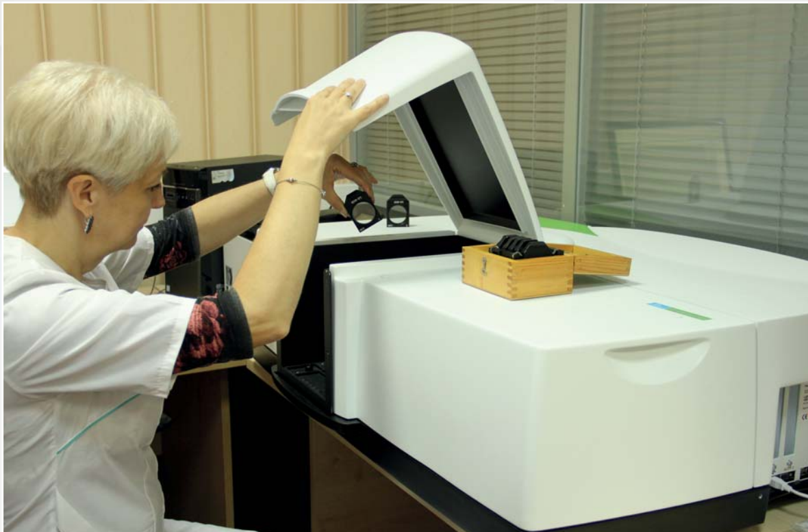
Проверка светофильтров спектрального коэффициента пропускания и отражения координат цвета и координат цветности на спектрофотометре LAMBDA 1050
