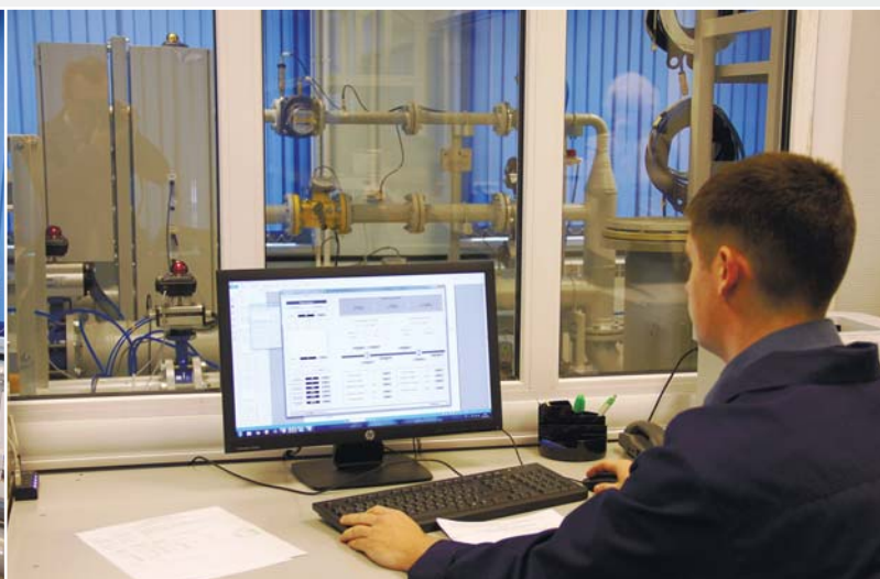
Автоматизированный процесс поверки промышленных счетчиков газа. Клинский филиал
