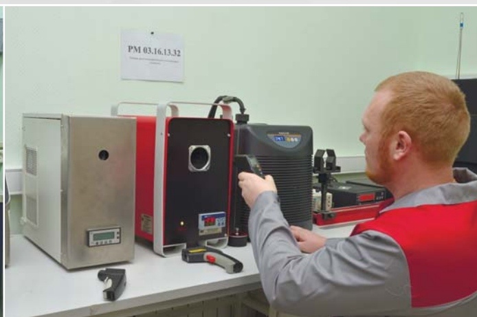
Поверка средств бесконтактного измерения температуры (пирометров и тепловизоров) в диапазоне измерений от минус 30 до плюс 800 °С. Менделеевский филиал
