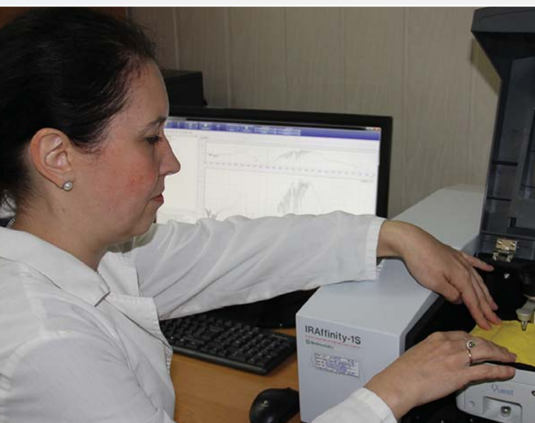
Определение качественного и количественного состава продукции легкой промышленности на ИК спектрофотометре Фурье
