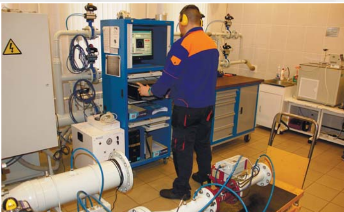
Поверка промышленного счетчика газа на поверочной установке УПГ 1/1600. Коломенский филиал
