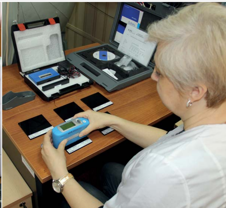
Поверка блескомеров с использованием набора эталонных мер
