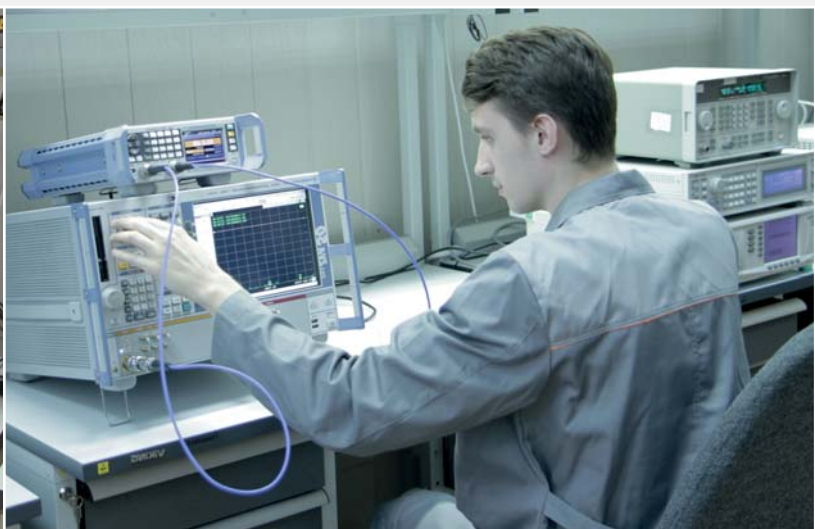
Метрологическое обслуживание радиотехнических СИ до 50 ГГц с использованием анализаторов электрических цепей
