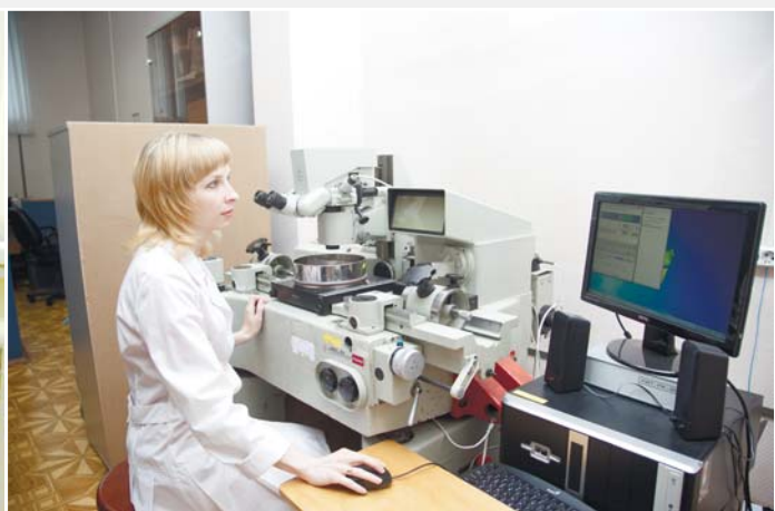
Поверка лабораторных сит на универсальном измерительном микроскопе УИМ-23. Орехово-Зуевский филиал
