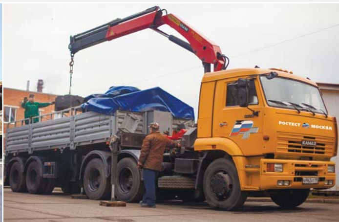
КПВ для поверки автомобильных весов до 80 тонн. Сергиево-Посадский филиал
