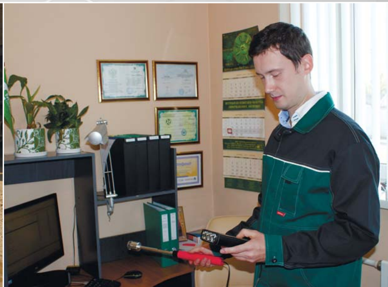
Измерение напряженности электростатического поля на рабочем месте
