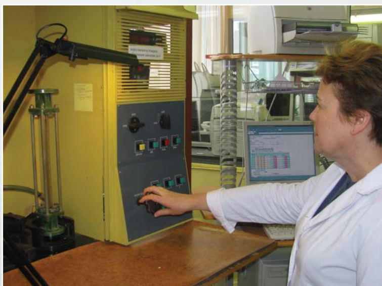
Автоматизированный процесс поверки промышленных счетчиков газа. Клинский филиал
