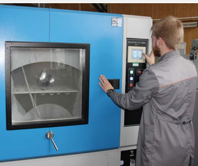
Камера для испытаний электрооборудования на защищенность от проникновения пыли
