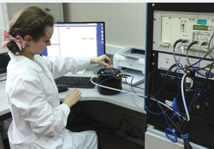
Рабочая станция (модель 9155), являющаяся эталоном первого разряда по ГОСТ 8.800-2012, предоставляет возможность проводить поверку и калибровку прецизионных датчиков вибрации последних моделей и модификаций
