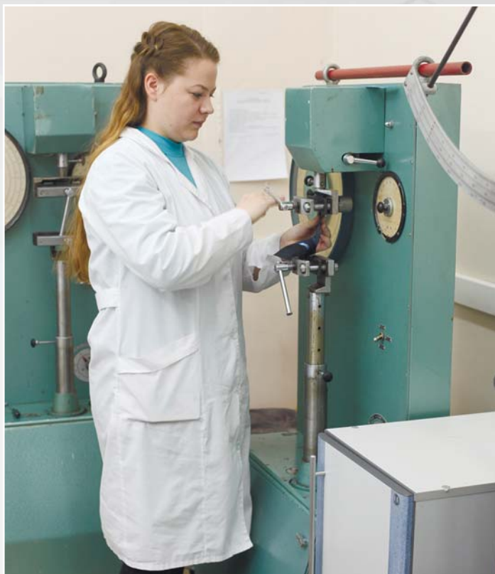
Определение разрывных характеристик ткани на установке РТ-250М. Сергиево-Посадский филиал
