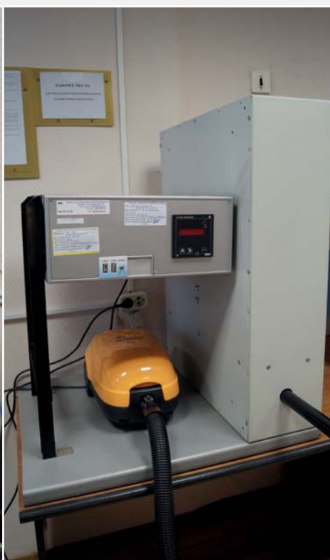
Определение пылепроницаемости специальной защитной одежды. Орехово-Зуевский филиал
