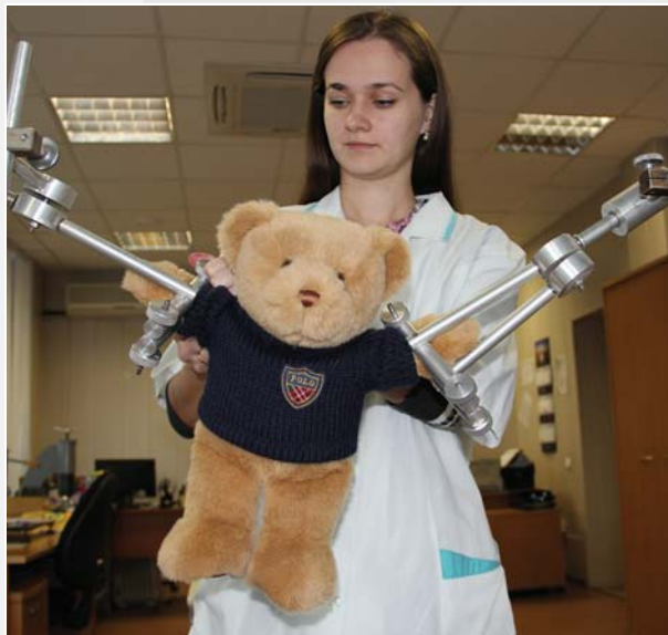
Испытания мягконабивных игрушек на прочность швов
