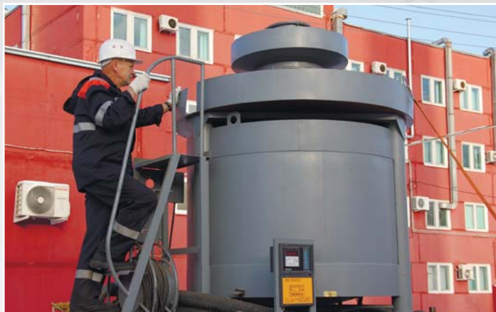
Установка поверочная СИ объема и массы верхнего и нижнего налива (УПМ-2000-03), используемая для поверки объемных и массовых счетчиков нефтепродуктов, а также измерительных систем АСН. Орехово-Зуевский филиал
