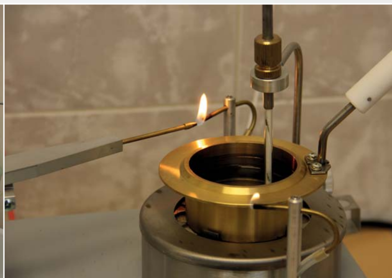
Определение температуры вспышки в открытом тигле в топочном мазуте
