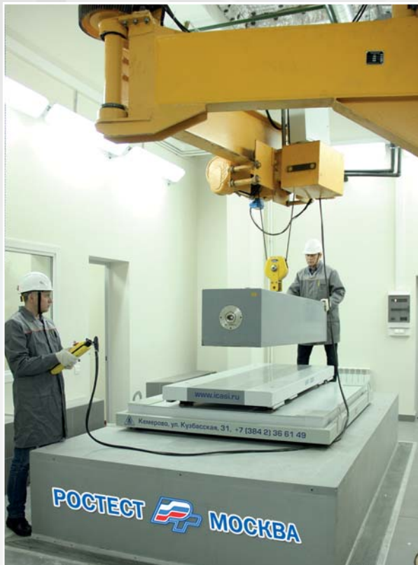
Поверка гирь с применением компаратора массы КМП-2000/3
