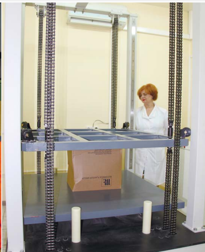
Испытания упаковки по параметру «сжимающее усилие». Сергиево-Посадский филиал
