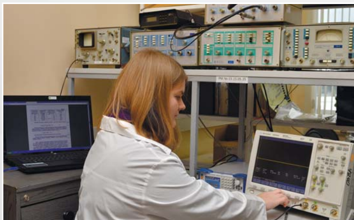
Рабочее место по поверке и калибровке осциллографов, вольтметров импульсного напряжения и калибраторов импульсного напряжения. Менделеевский филиал
