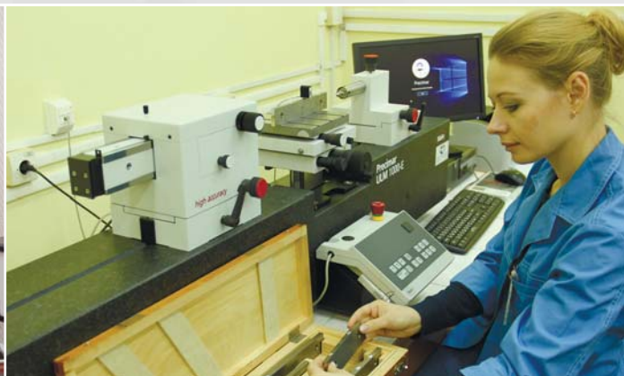
Поверка и калибровка мер длины концевых 3 разряда до 1000 мм и эталонных колец 3 разряда до 900 мм на рабочем эталоне 2 разряда. Сергиево-Посадский филиал
