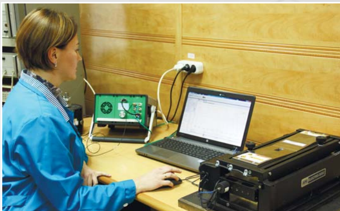
Поверка рабочих СИ вибрации на эталонной поверочной виброустановке. Клинский филиал
