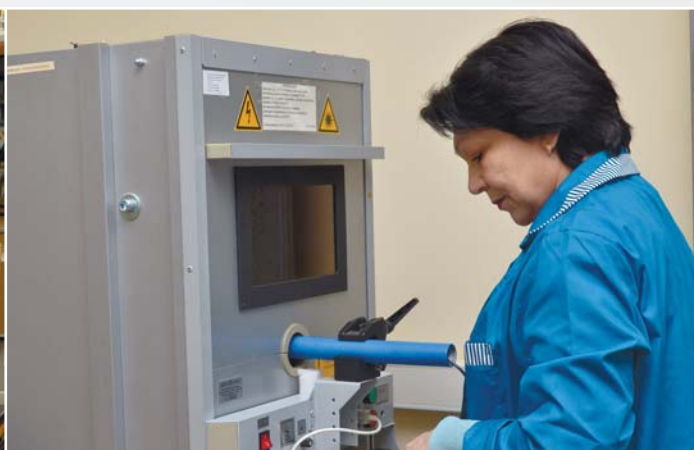
Установка поверочная СИ напряженности электрического поля промышленной частоты П1-24 (рабочий эталон 2 разряда). Менделеевский филиал
