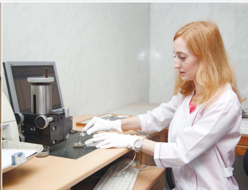
Поверка мер длины концевых плоскопараллельных на установке УКМ-100. Орехово-Зуевский филиал
