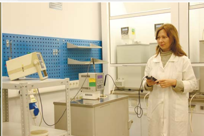
Поверка цифрового термометра на жидкостном низкотемпературном термостате Термотест-05-02. Коломенский филиал
