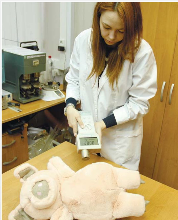
Определение уровня напряженности электростатического поля мягконабивной игрушки
