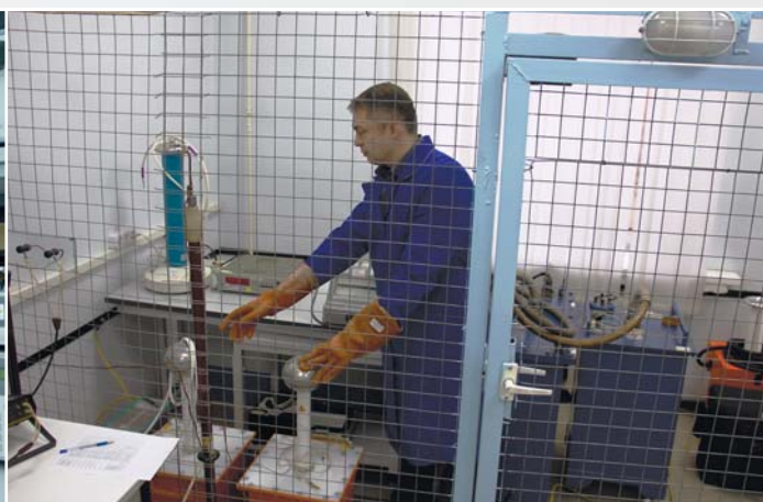
Рабочее место по поверке, калибровке и аттестации высоковольтных испытательных установок Клинский филиал
