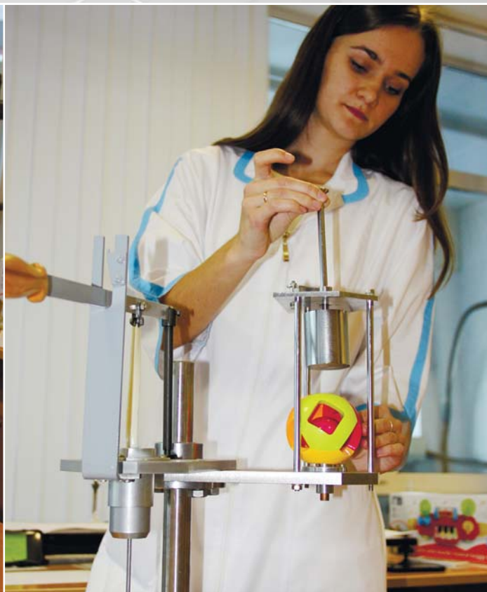
Определение герметичности игрушки с жидким наполнителем
