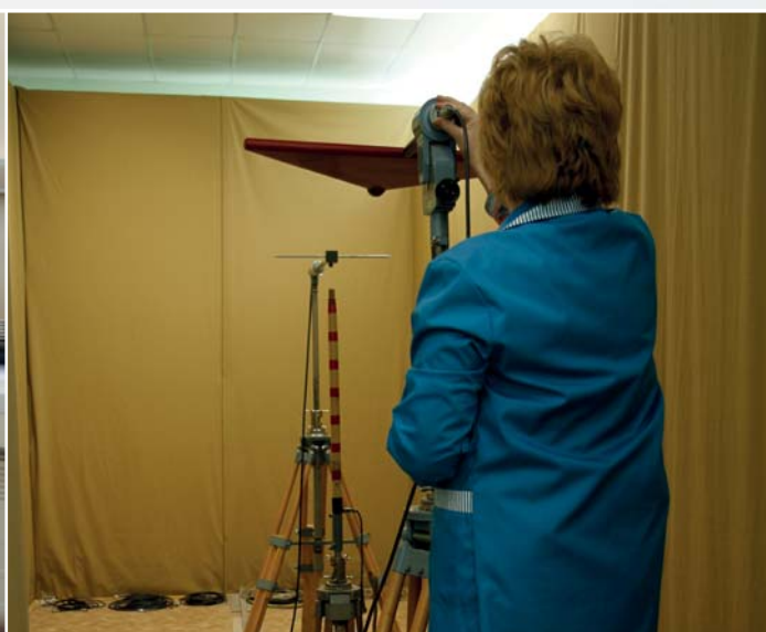
Поверка СИ напряженности поля и антенн измерительных с помощью образцовой установки П1-5 (рабочий эталон 2 разряда). Менделеевский филиал
