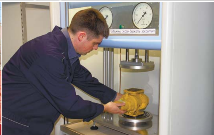
Испытания счетчика газа на герметичность. Клинский филиал
