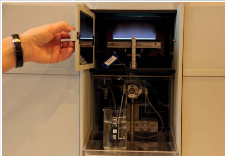
Определение концентрации свинца в автомобильных бензинах
