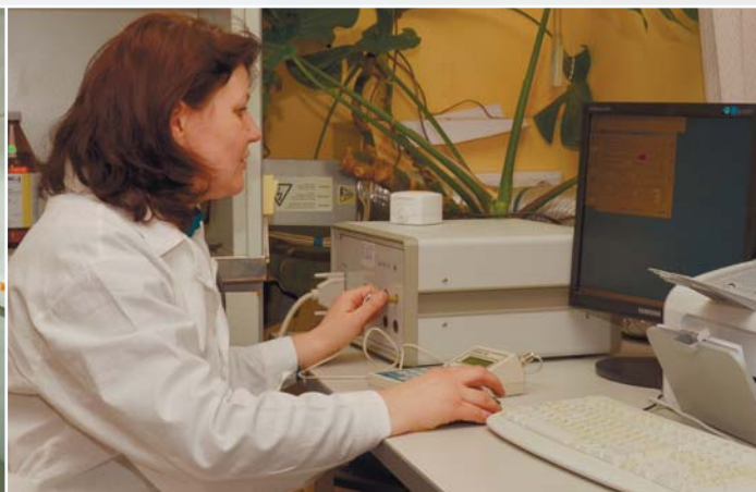
Поверка pH-метров и ионометров на установке pH-ТЕСТ 01. Менделеевский филиал
