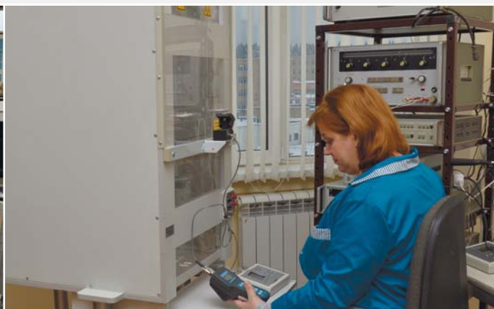
Установка поверочная СИ напряженности электрического поля П1-21 (рабочий эталон 2 разряда). Менделеевский филиал
