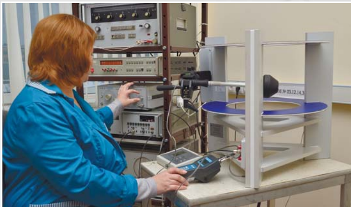
Установка поверочная СИ напряженности магнитного поля П1-22 (рабочий эталон 2 разряда). Менделеевский филиал
