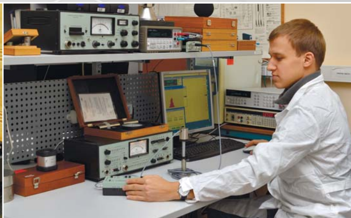
Государственный рабочий эталон единицы звукового давления в воздушной среде. Менделеевский филиал
