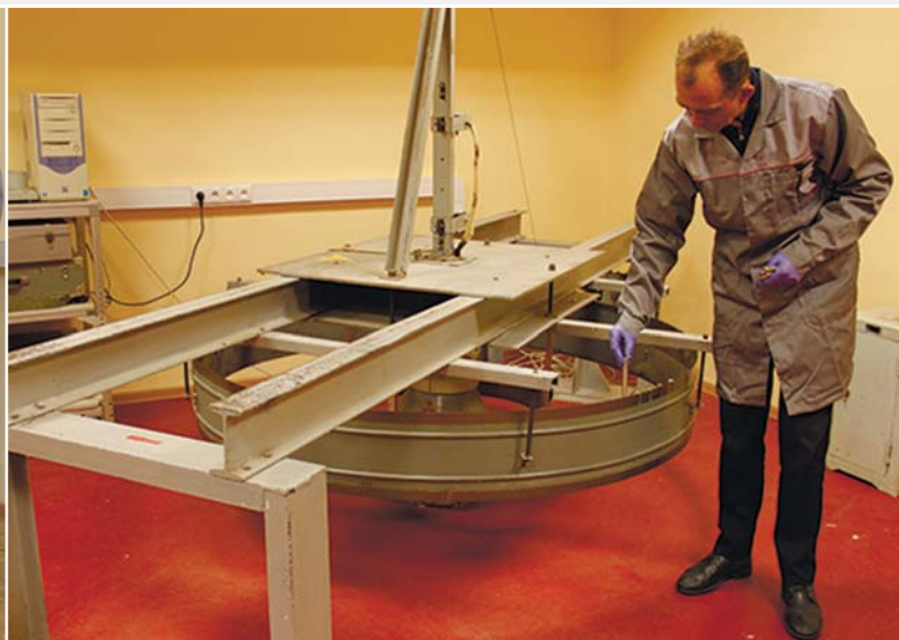
Поверка индивидуальных дозиметров фотонного излучения на установке УПИД-2 (рабочий эталон 2 разряда по ГОСТ 8.804-2012)
