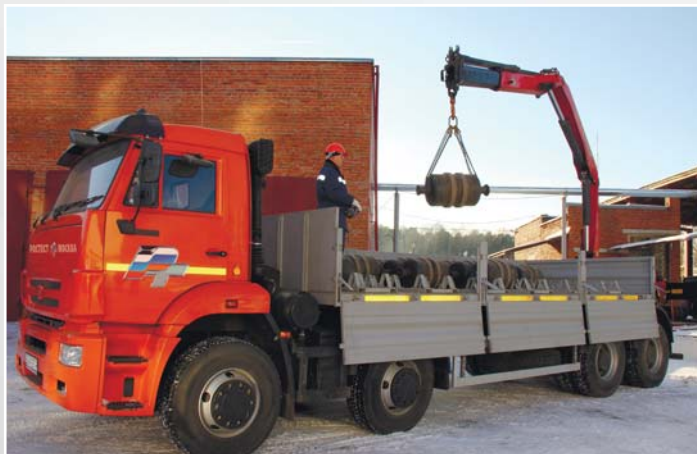
КПВ для поверки автомобильных весов до 100 тонн. Орехово-Зуевский филиал
