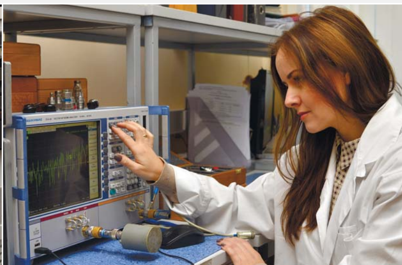
Измерение ослабления электромагнитных колебаний в диапазоне значений от 0 до 85 дБ и в диапазоне частот от 10 до 40000 МГц на векторном анализаторе электрических цепей (рабочий эталон 1 разряда). Менделеевский филиал
