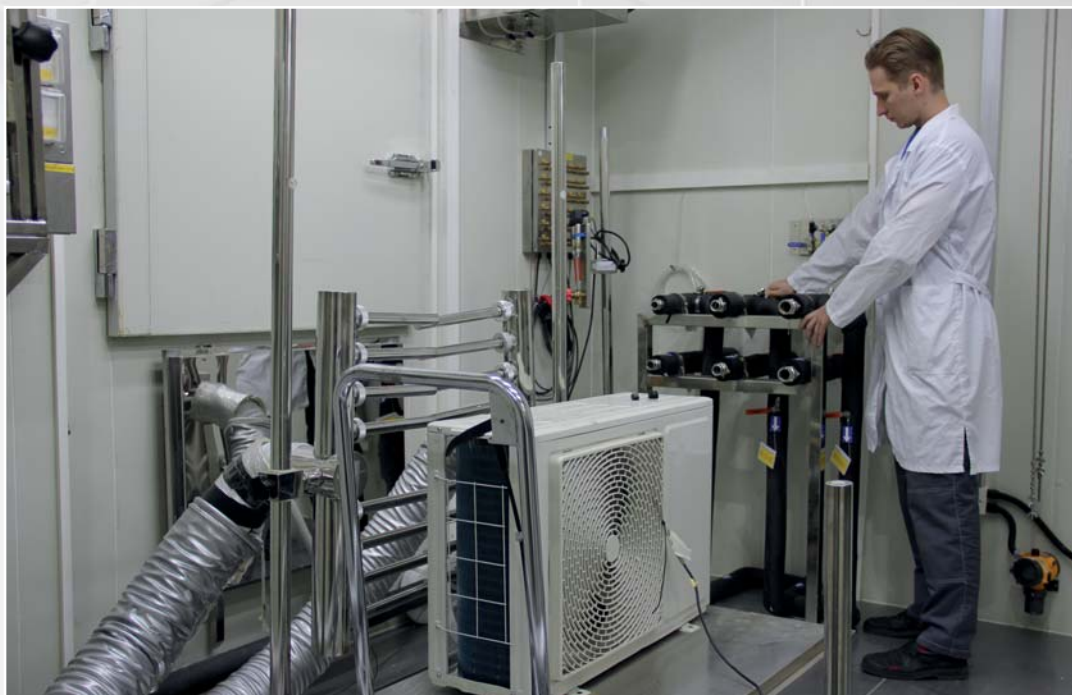
Стенд для испытаний наружного блока кондиционеров
