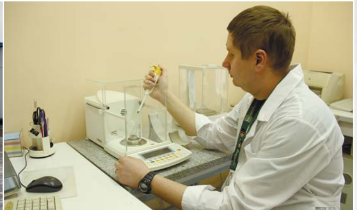
Поверка одноканальных и многоканальных дозаторов с диапазоном дозирования от 1 до 50000 мкл (весы лабораторные и электронные с пароуловителем). Сергиево-Посадский филиал
