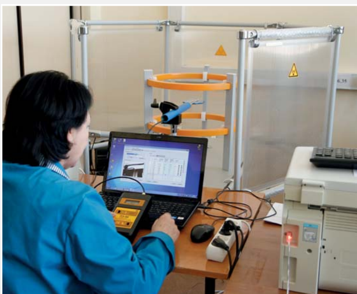
Установка поверочная СИ напряженности магнитного поля промышленной частоты 50 Гц П1-26. Менделеевский филиал
