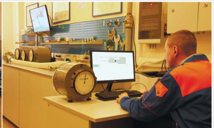
Поверка газового счетчика на поверочной установке АУРС-М-65-Р. Коломенский филиал
