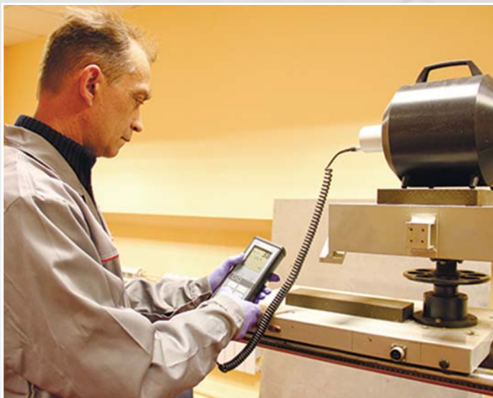
Проверка дозиметров нейтронного излучения на установке УКПН-2 (рабочий эталон 1 разряда по ГОСТ Р 8.803 — 2012)
