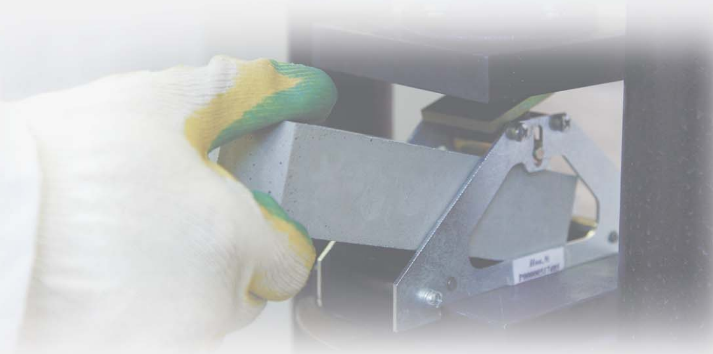
Испытания строительных материалов на сжатие
