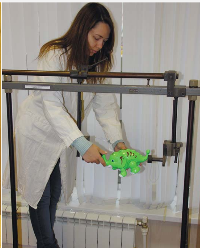
Испытание прочности корпуса игрушки
