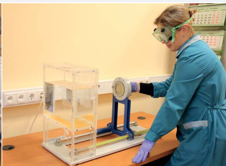
Проверка индивидуальных дозиметров бета-излучения на установке УПБ-ИД (рабочий эталон по ГОСТ 8.035-82)
