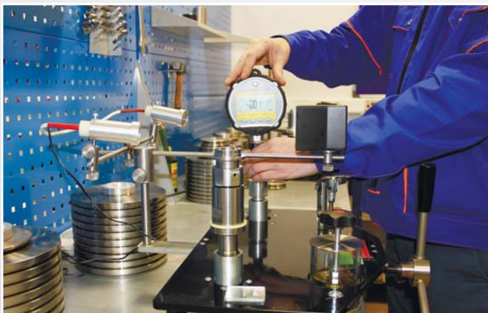
Поверка цифровых манометров на грузопоршневом манометре типа МП. Коломенский филиал
