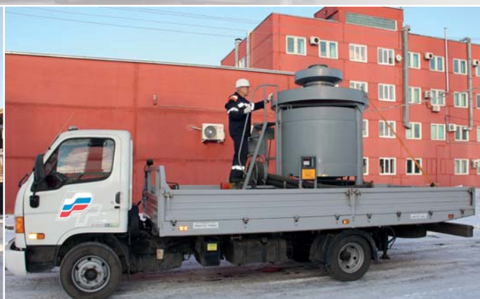
Передвижная поверочная установка СИ объема и массы верхнего и нижнего налива (УПМ-2000-03) для проверки объемных и массовых счетчиков нефтепродуктов, а также измерительных систем АСН. Орехово-Зуевский филиал
