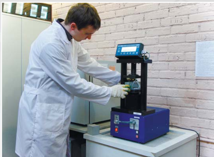
Испытания строительных материалов на сжатие
