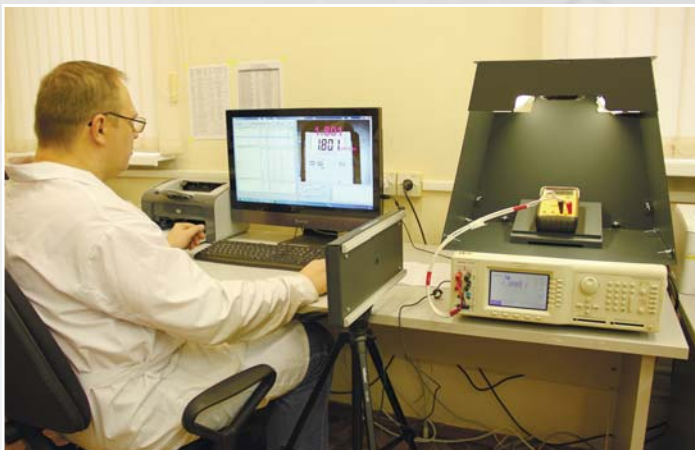
Автоматизированное рабочее место по поверке и калибровке цифровых мультиметров и вольтметров с использованием модуля машинного зрения Сергиево-Посадский филиал
