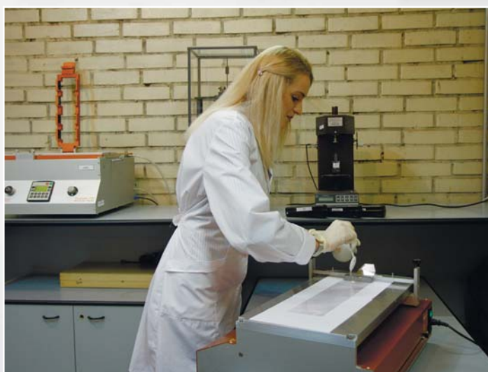
Пробоподготовка лакокрасочных материалов к испытаниям на истираемость и очистке на Elcometer 1720
