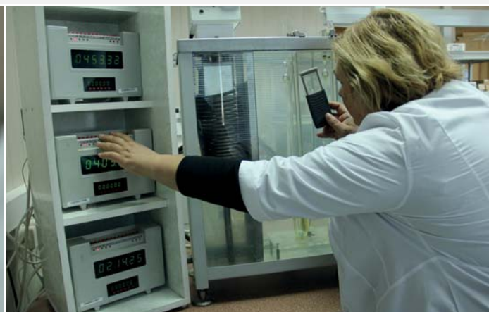
Поверка вискозиметров с использованием эталона вязкости
