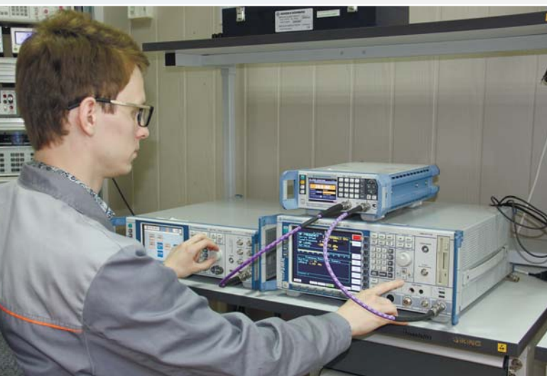
Проверка и калибровка фиксированных и ступенчатых аттенюаторов, анализаторов спектра, генераторов сигналов с помощью рабочего эталона единицы ослабления 1 разряда
