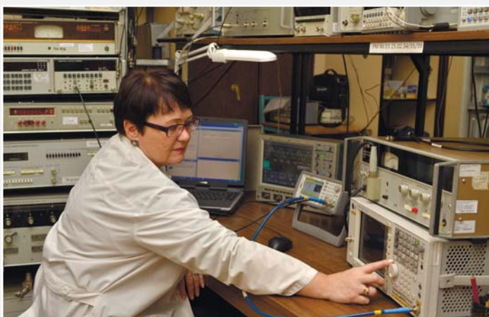
Рабочее место по поверке и калибровке низкочастотных генераторов сигналов и высокочастотных вольтметров. Менделеевский филиал
