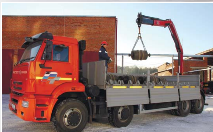
КПВ для проверки автомобильных весов до 100 тонн. Орехово-Зуевский филиал
