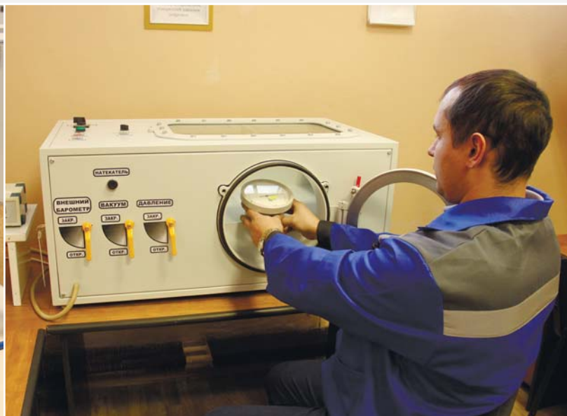
Поверка барометров и измерителей атмосферного давления с использованием барометра образцового БОП-1М и барометрической камеры. Орехово-Зуевский филиал
