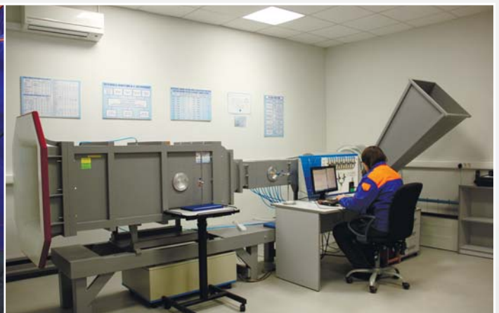
Поверка анемометров на аэродинамической измерительной установке ЭМС 0,1/60. Коломенский филиал
