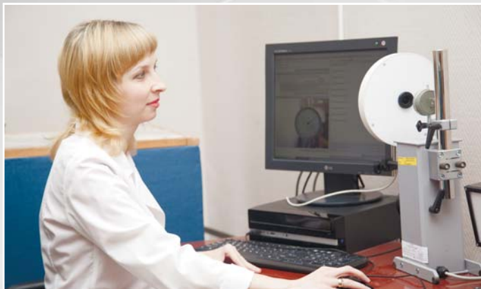
Поверка индикатора часового типа на приборе ППИ-50. Орехово-Зуевский филиал
