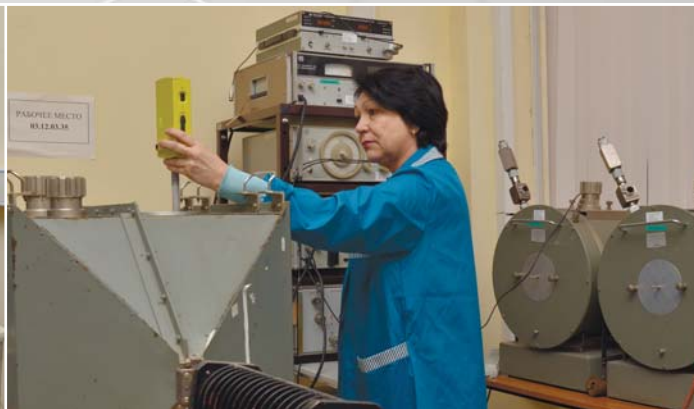
Установка для поверки измерителей напряженности электромагнитного поля П1-8 (рабочий эталон 2 разряда). Менделеевский филиал
