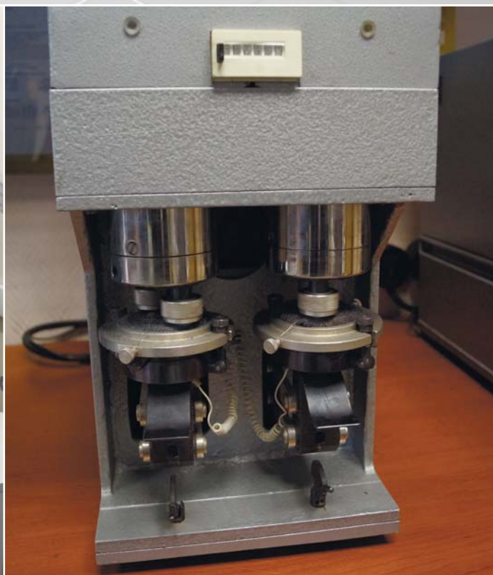
Испытания тканей на стойкость к истиранию по плоскости. Орехово-Зуевский филиал
