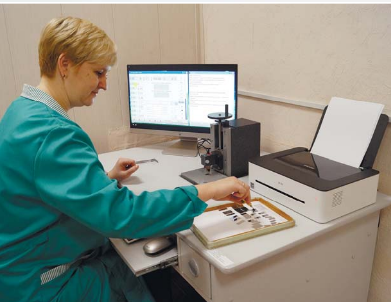
Поверка мер длины концевых плоскопараллельных 2 разряда на установке измерительной КИТ КМД. Клинский филиал
