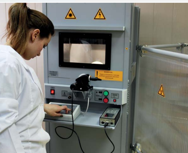
Установка поверочная средств измерения напряженности электрических полей П1-24
