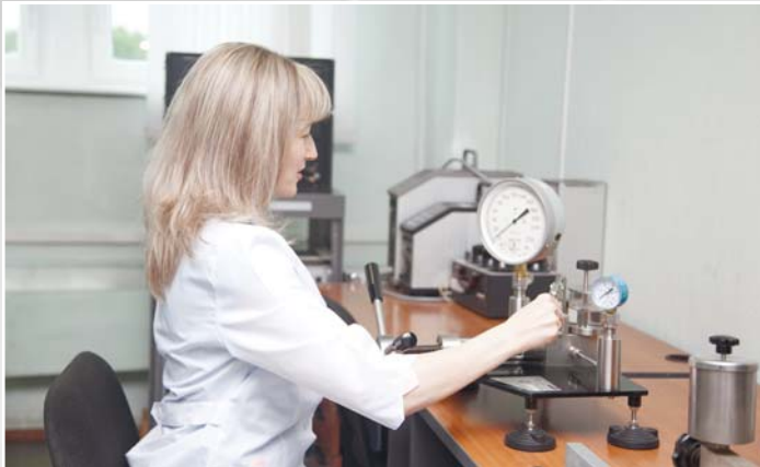
Поверка кислородных манометров на приборе ППКМ. Орехово-Зуевский филиал
