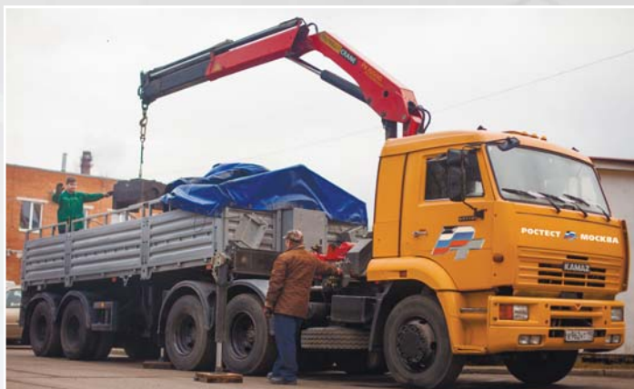
КПВ для проверки автомобильных весов до 80 тонн. Сергиево-Посадский филиал
