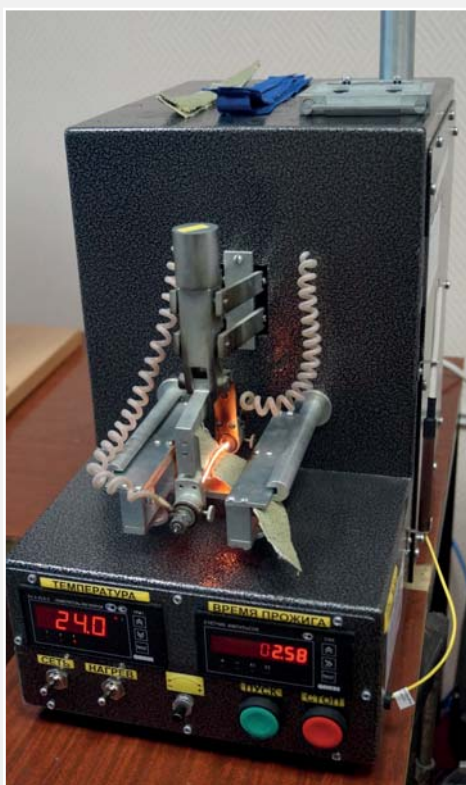
Определение огнеупорных свойств защитных материалов. Орехово-Зуевский филиал
