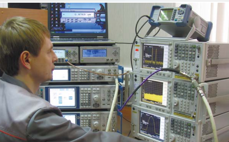
Проверка анализаторов спектра, применяемых для контроля и настройки НЧ, ВЧ и СВЧ оборудования в теле- и радиовещании, связи и телекоммуникациях
