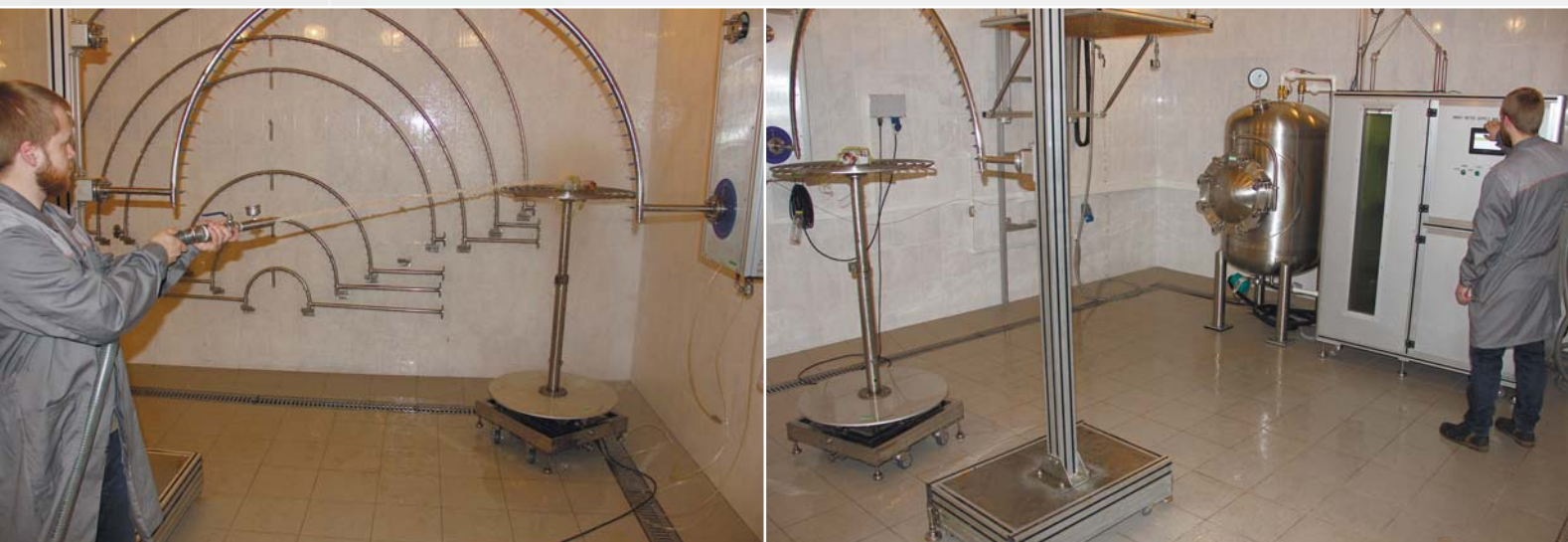
Испытательный стенд имитации дождя для проверки электрооборудования на защищенность от проникновения воды
