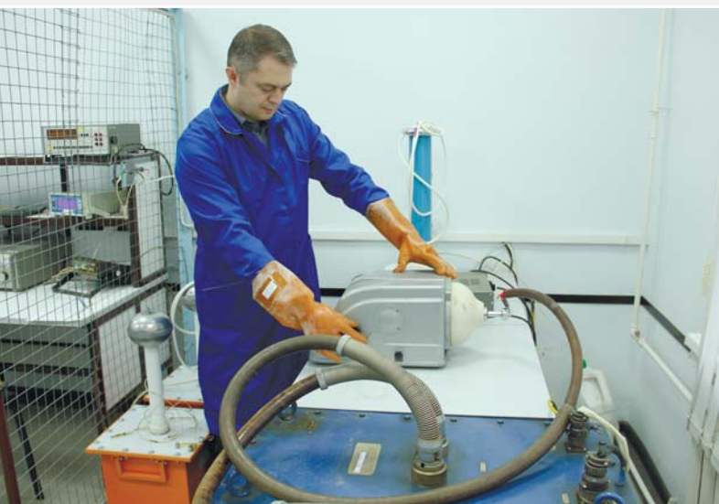
Рабочее место по поверке и калибровке киловольтметров и измерительных систем высокого напряжения Клинский филиал
