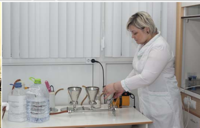
Исследование образцов воды на БГКП с использованием фильтровальной установки. Сергиево-Посадский филиал
