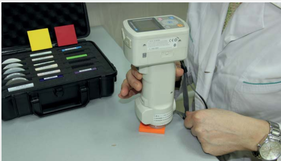
Набор мер отражающих НМОКЦЦ-1 для передачи размера единиц координат цвета и координат цветности при проверке спектроколориметров, используемых для измерения цветовых характеристик окрашенных поверхностей
