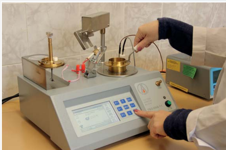
Определение температуры вспышки в закрытом тигле в дизельном топливе
