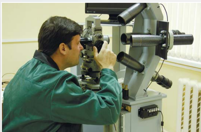
Стенд универсальный коллиматорный ВЕГА УКС для поверки геодезического оборудования. Клинский филиал
