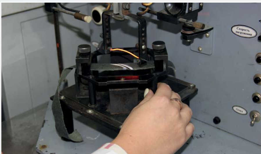
Определение стойкости к прожиганию материалов для спецодежды. Сергиево-Посадский филиал
