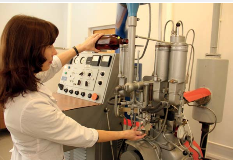
Определение октанового числа автомобильного бензина
