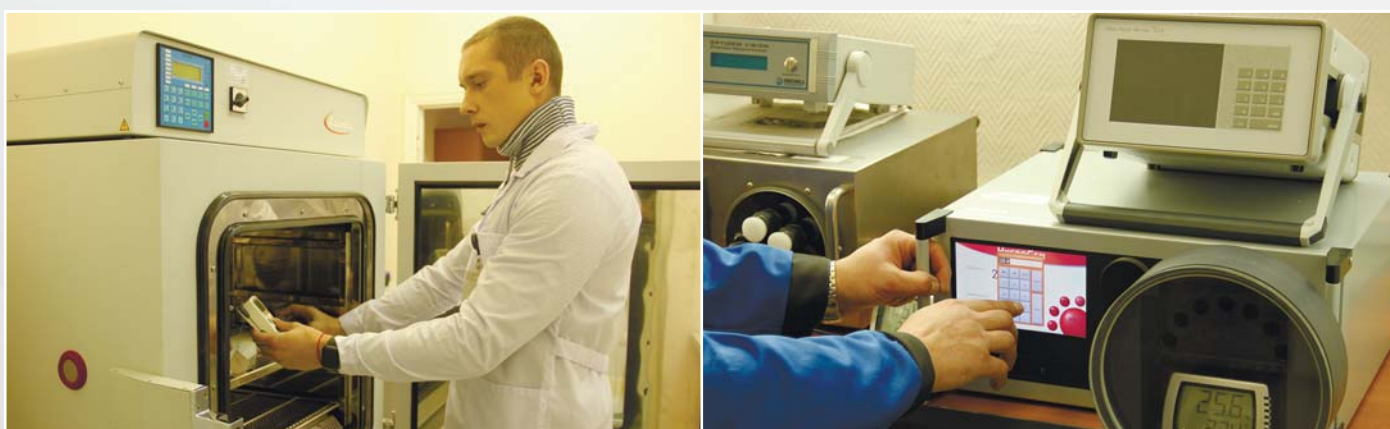
Поверка термогигрометров с применением климатической камеры в диапазоне воспроизводимой температуры от минус 75 С° до 180 С° и относительной влажности от 10 до 98 %. Сергиево-Посадский филиал
