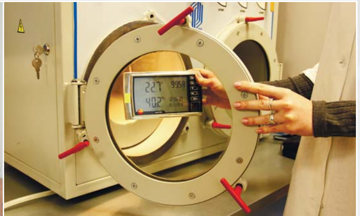
Поверка канала абсолютного давления комбинированного прибора в барокамере. Коломенский филиал
