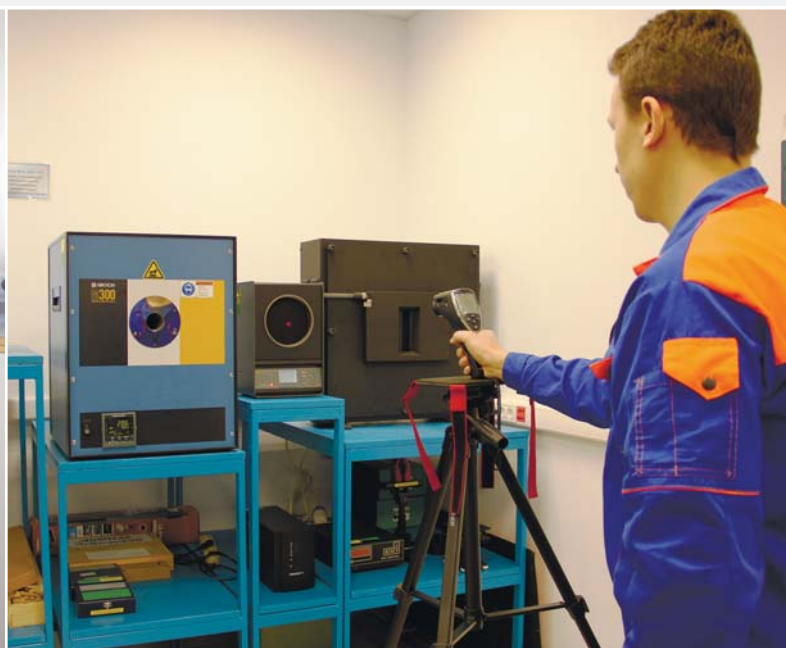
Поверка средств бесконтактного измерения температуры (пирометров и тепловизоров) в диапазоне измерений от минус 20 до плюс 1150 °С. Коломенский филиал
