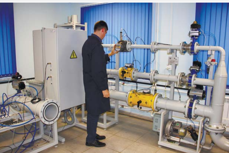
Установка для поверки и калибровки счетчиков газа 1 разряда УПРС-1600. Клинский филиал
