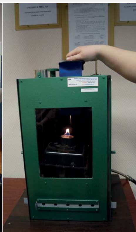
Определение стойкости тканей и материалов к повышенным температурам. Орехово-Зуевский филиал
