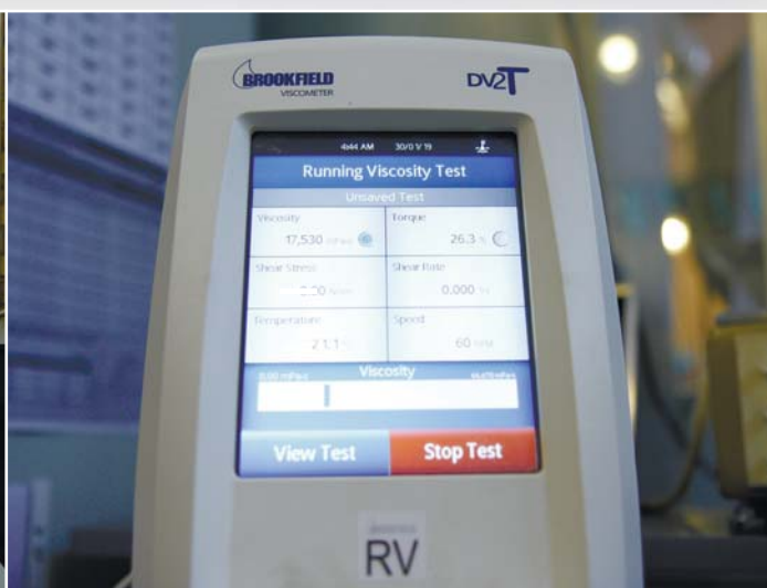
Измерение вязкости материалов и жидкостей на ротационном вискозиметре Брукфильда
