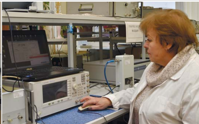
Установка для поверки ваттметров СВЧ УПВ-1 (рабочий эталон 1 разряда). Менделеевский филиал
