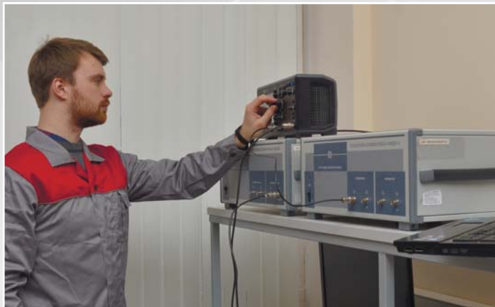
Установка поверочная для СИ коэффициента амплитудной модуляции РЭКАМ и СИ девяти частоты РЭЕДЧ-1 (рабочие эталоны 0 разряда). Менделеевский филиал
