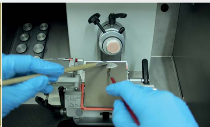
Гистологический срез вареного мясного изделия на полуавтоматическом криостате. Орехово-Зуевский филиал
