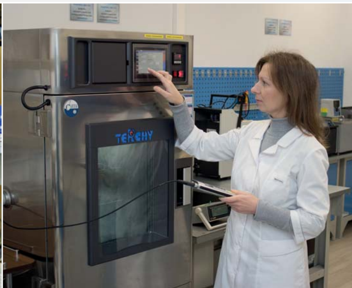
Поверка термогигрометров с применением климатической камеры в диапазоне воспроизводимой температуры от минус 40 С° до плюс 150 С° и относительной влажности от 10 до 98 %. Коломенский филиал
