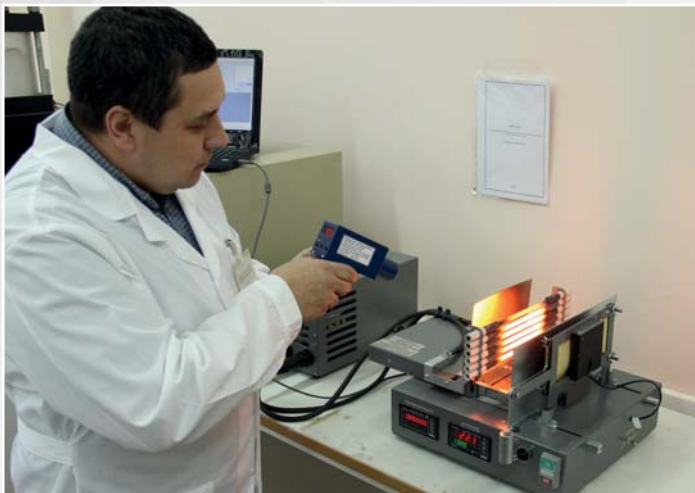
Испытания по показателю «индекс передачи теплового излучения» на приборе ТИ-2. Сергиево-Посадский филиал
